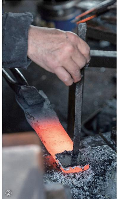
① 炉の温度は1,100℃。高すぎると鋼が駄目になり、低すぎると鋼と地金が接合しない。高温に耐えながら、炎の見た目と肌の感覚で、温度を見極める。② 炉で赤めた高温の地金に、接合材を付けた鋼を乗せて押しつける。この後、再び炉で赤め、ハンマーで叩いて鍛接する。③ 工場の一角にストックされた地金用の鉄材。硬い鋼を受ける地金には軟鉄が最適とされるが、現代では確保が困難。明治時代にイギリスから輸入された鉄道の線路や鉄橋、船の錨や鎖などの廃材を用いる。④ 事務スペースの一角には多彩な鋼材を収蔵展示。工場見学や相談に訪れる人に、詳しく説明することも。⑤ 広い工場の半分以上を占めるスペースには、ハイス鋼など特殊鋼を扱うための大型機械が多数。⑥ 鍛冶仕事、素材の特徴や相性など、三代目の鉋語りは一聴の価値あり。⑦ 代表する銘品、伝統常三郎、和合。刻まれた言葉に、歴史と伝統が感じられる。
