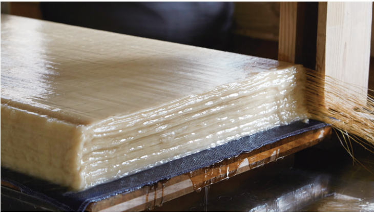
上) 楮の紙素を楯の棒で約1時間打ち続ける、打解(紙素打ち)の工程。 中) 打ち延ばした紙素には楮の繊維が残り、宇陀紙独特の強度と風合いを生む。 下) 漉いた紙を丁寧に積み上げ、压榨と天日干しを経て完成となる。
