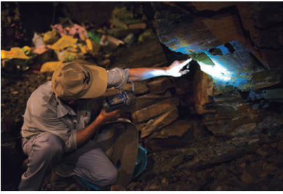
▲亀岡市北西部、丸尾山の山中に掘られた採掘場。長年の経験をもとに地層の違いを見極め、上質な砥石層を掘り当てていく。火薬による発破もあるが、基本的には地道な手作業
