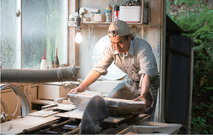
▶おおよそのサイズと形に切り出した砥石は、水平を保った回転盤に当てて表面を研磨。この後、手作業による仕上げの研磨を経て、天然砥石が完成する。同じものは二つとない、文字通りの一点ものだ
