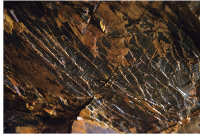
▲亀岡市北西部、丸尾山の山中に掘られた採掘場。長年の経験をもとに地層の違いを見極め、上質な砥石層を掘り当てていく。火薬による発破もあるが、基本的には地道な手作業
