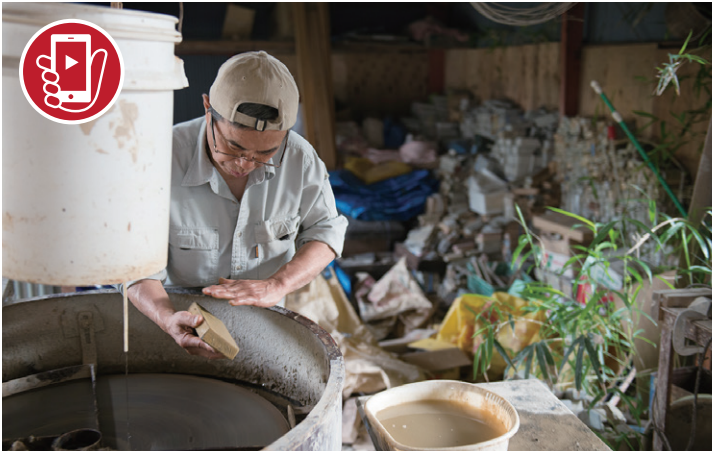
▶おおよそのサイズと形に切り出した砥石は、水平を保った回転盤に当てて表面を研磨。この後、手作業による仕上げの研磨を経て、天然砥石が完成する。同じものは二つとない、文字通りの一点ものだ
