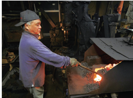
炉内の温度は、最高で1200℃近くに達する。量産作業の場合、2口の炉を同時に使うことも。
