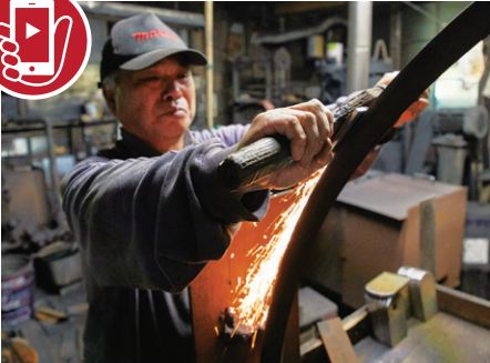
ペーパー砥やペーパー車と呼ばれる、与板独自のグラインダーを使って行われる裏すきの工程。
