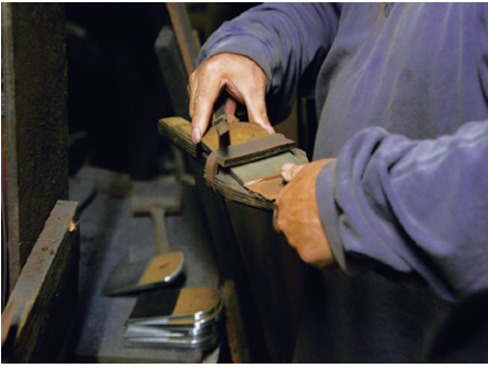
グラインダーにかける際に刃を固定する道具も自作。滑らかなフォルムと色艶は使い込まれた証。
