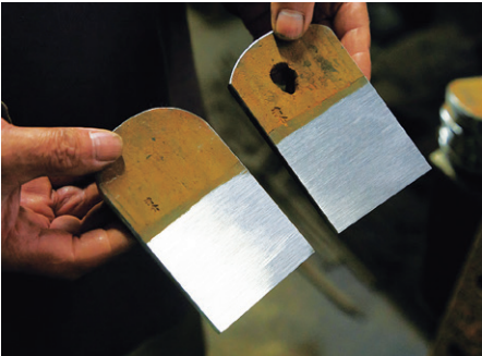
裏すきを終えた刃。凹凸が少なく、鏡のような仕上がり。与板で作られる鉋の特徴のひとつだ。
