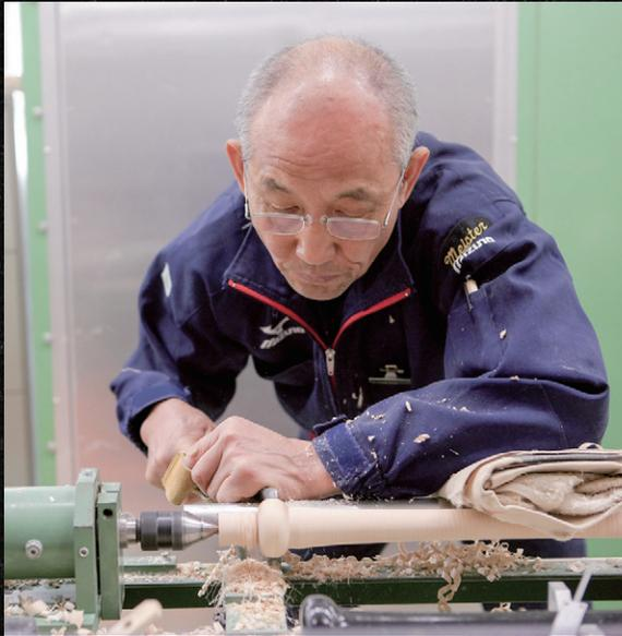
旋盤に固定された木材が高速に回転し始めた、流れる手つきで久保田氏が次々と道具を変えて形を整えていく。皮一枚それはミクロンの世界、そんな繊細な作業の繰り返し。「これがイチローさんが使っているバットです」作業を終え、旋盤から外されたバットを受け取る。「華奢なバット」それが手にした初めの感想だった。入社して53年、中学校を卒業してからこの道一筋に徹してきた。バットを作る上で一番肝心なのは素材選びという。日光の当たる角度や水や土壌、気候の差で大きく質が変わる木々、その切りだされた何分の一に光る材を見つけた時はとても嬉しいという。「いい木を見たら、手先が勝手に動いてくれるんですよ」。木材のことはおろか、木工建築や道具となる鋼のことまで造詣の深い久保田氏の話は弾む。この飽くなき探究心こそが、久保田さんの原動力となっていることを実感した。
