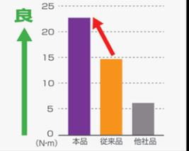
ドリルのすべり始めトルク比較 (各チャックを同トルクで締め付けた時)
