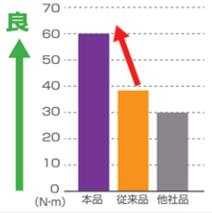
ボディカバーの破壊トルク比較
