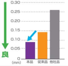
回転時の先端工具の芯ブレ比較
